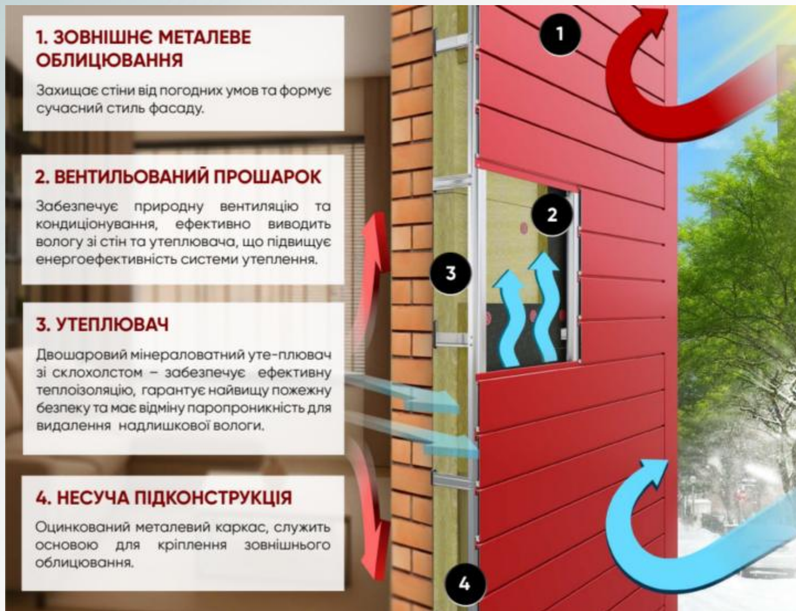
Мал. 15. принцип дії навісного вентильованого фасаду
