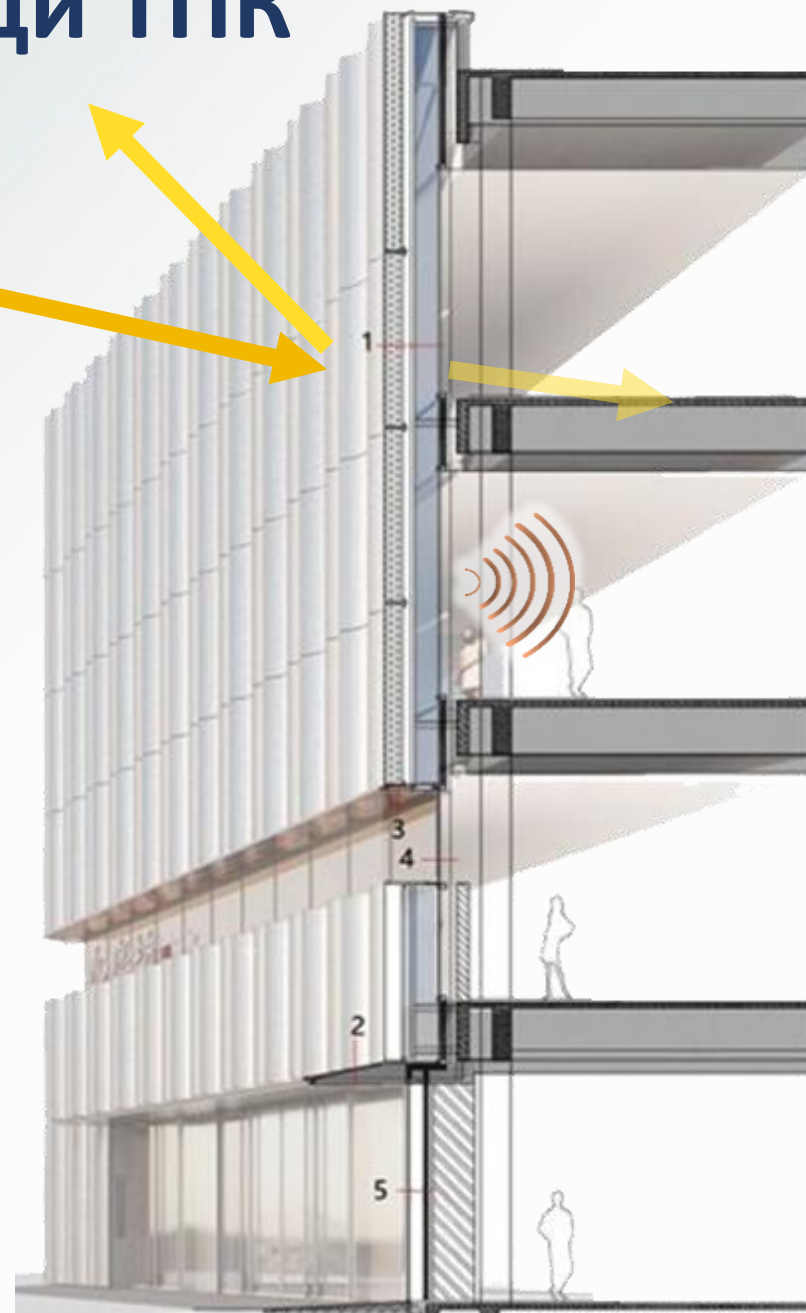
Мал. 16. принцип дії навісного перфорованого фасаду
